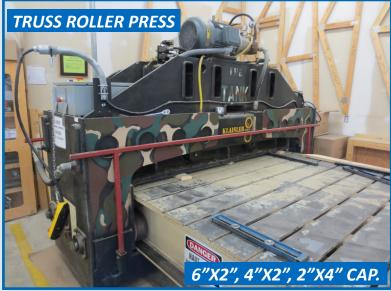
KLAISLER TP-08-70 AR TRUSS FINISHING ROLLER PRESS
